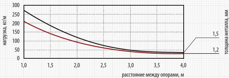
график допустимых нагрузок для лестничных лотков с высотой борта 70мм
